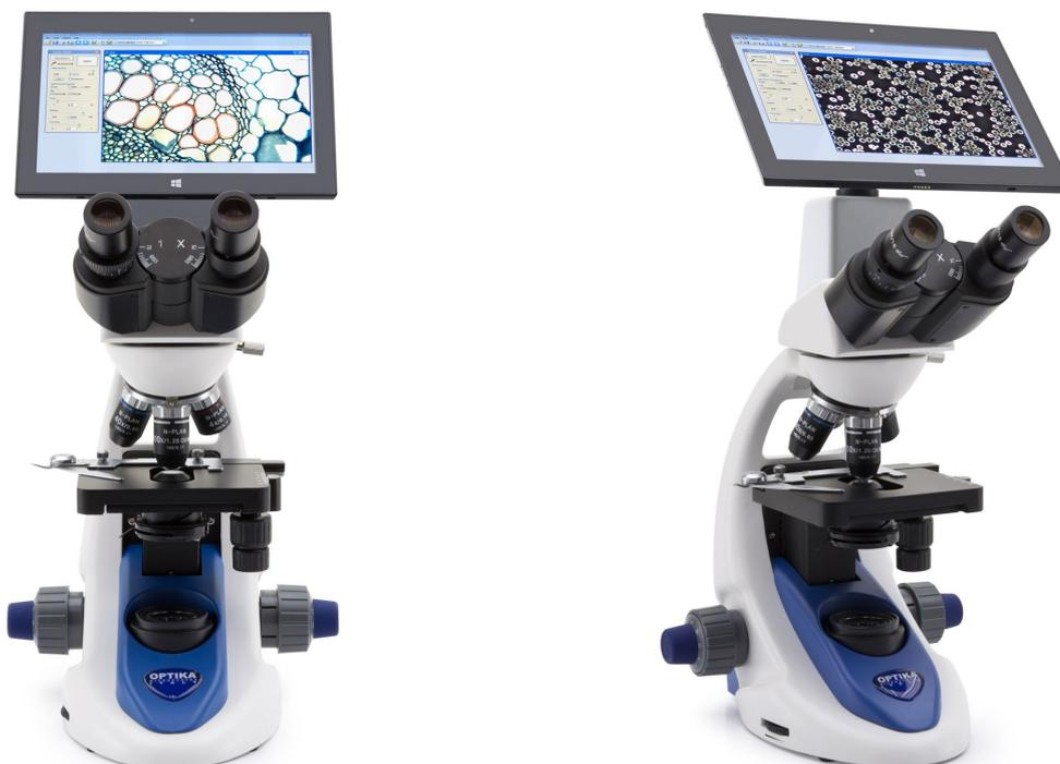
Microscopio binoculare digitale con quattro obiettivi N-PLAN (1000x), oculare alto FN 18, sistema ottico finito, messa a fuoco coassiale, tavolino meccanico, condensatore Abbe e potente, uniforme, temperatura di colore bianca 3W X-LED2 illuminazione.
